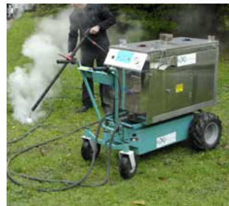
Petit module de désherbage thermique à vapeur
