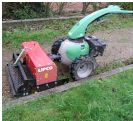
Sabot rotatif monté sur cellule, pour le désherbage de surfaces stabilisée.
